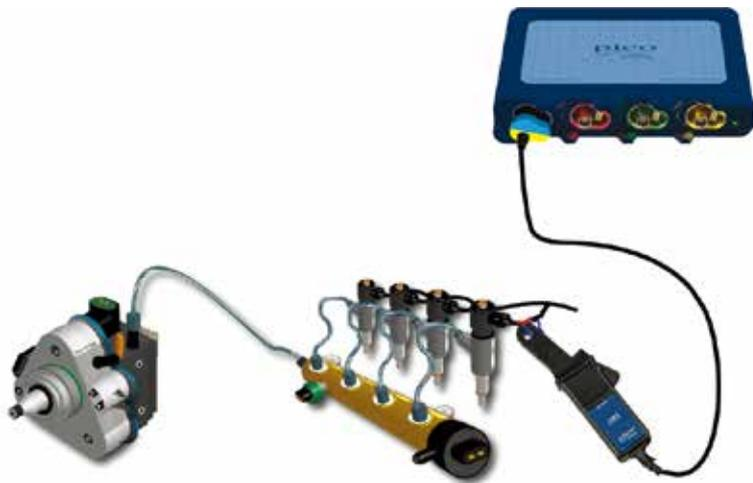
1. 将小电流钳连接到Pico示波器的通道A上。
