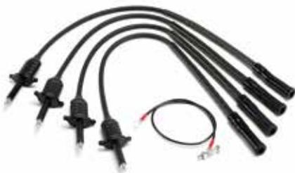
这套延长线特别适用于多个COP点火线圈。简单地把每根延长线安装在每个线圈和火花塞之间，然后把MI074次级点火拾取线夹在每根延长线上。示波器将会显示准确的点火波形和正确的千伏电压值。
