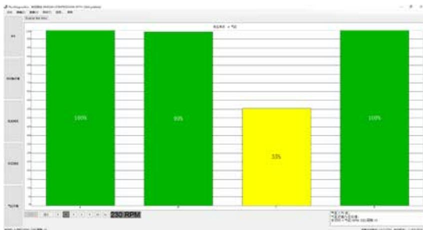
备注：PicoDiagnostics软件支持两种不同类型的压缩测试：相对压缩和绝对压缩。但是，必须使用WPS500X压力传感器才能执行绝对压缩测试。
