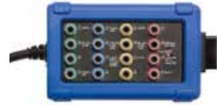
我们的CAN测试盒可把Pico汽车示波器连接到车辆的16针脚OBD接头上。我们建议使用此方法来测试车辆CAN信号（请参见引导测试AT126）。CAN测试盒的接线端适用于标准的4mm插头。
