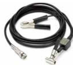
MIO74是一种电容式的拾取器，连接在点火电路部件的绝缘层(如点火高压线)周围，避免了直接连接高电压。MIO74与高压点火延长线匹配使用，可以同时检测多个COP点火信号。
