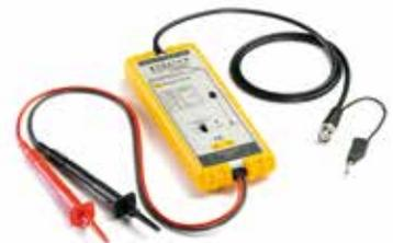
添加我们的1400V差分探头到任何套装，它可以测量更高的电压，特别适用于混合动力和电动汽车。这个探头的带宽为25MHz，差分电压范围为1400V，CAT III等级。
