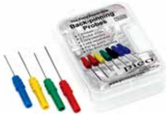
后背刺针从线束连接器背面的绝缘层一侧滑进去，让你拾取信号而不需要剥开电线或断开连接器。包括备用探针和螺丝，这对任何诊断技术人员都是必不可少的。
