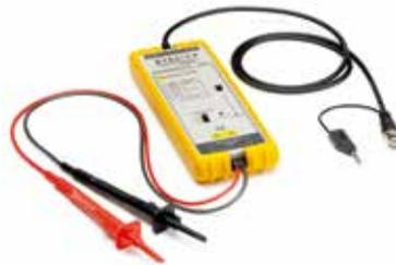
添加我们的700V差分探头到任何套装，它可以测量更高的电压，特别适用于混合动力和电动汽车。这个探头的带宽为25MHz，差分电压范围为700V，CAT III等级。
