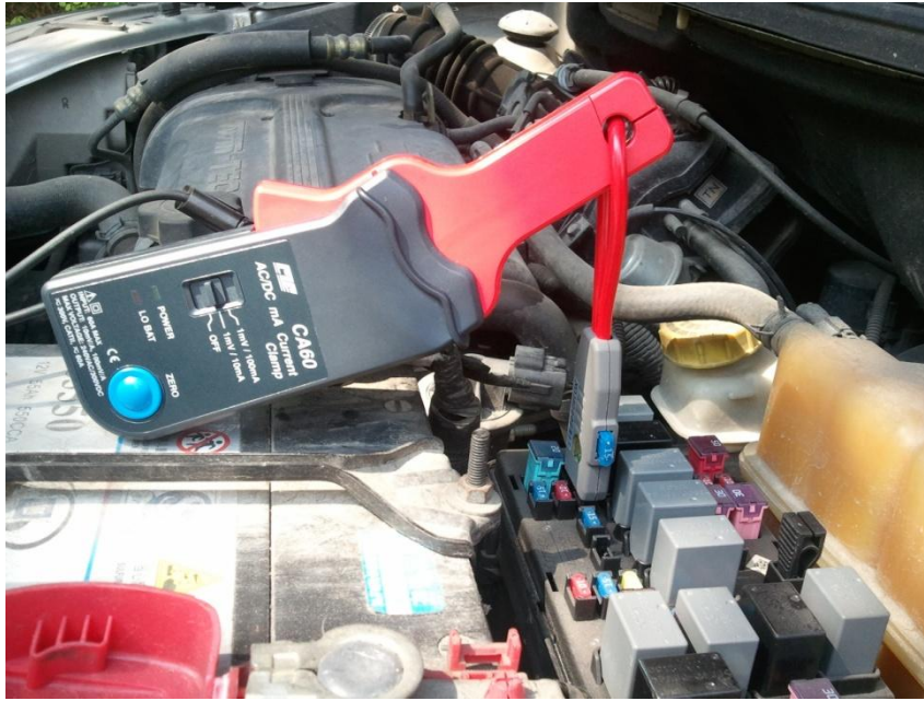
图（14）保险丝延长线连接示例
