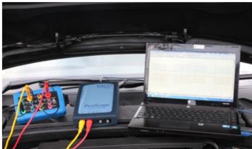
图（17）CAN 测试盒连接示例
