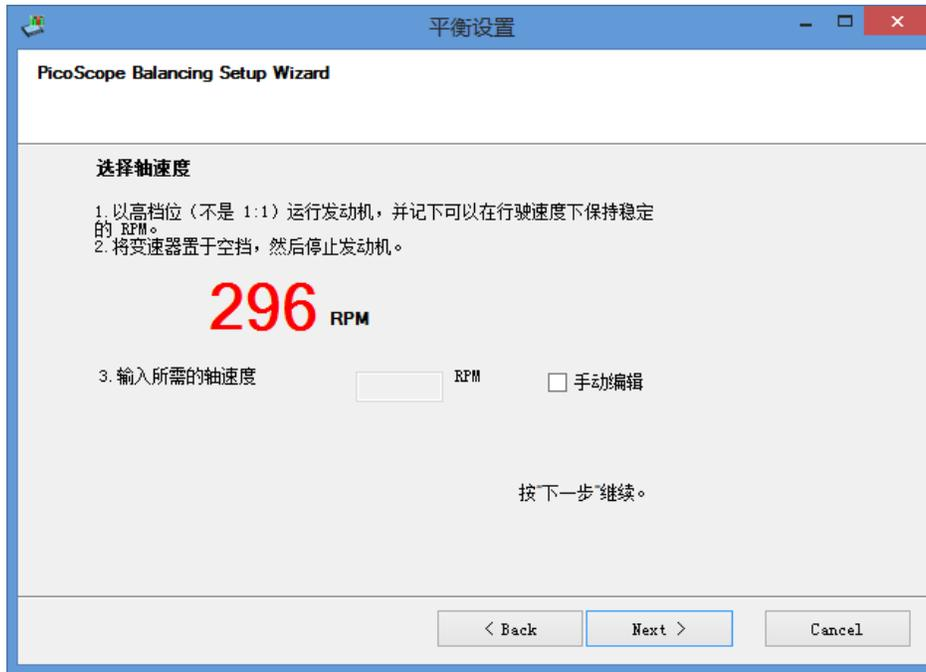
当车辆在稳定的速度且读数被采取, RPM 会变绿色, 并被自动地输入进 RPM 框里:
