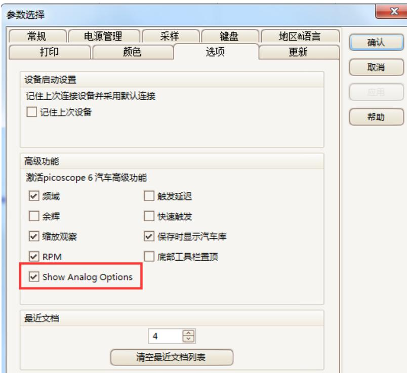
2、如果您利用A通道来检测漏电电流，则点击通道选项A，在探头一项，如果使用的是TA234电流钳则选”30A Current Clamp“，如果使用的是TA018电流钳则选”60A Current Clamp (20A mode)”；并且模拟选项勾选”20 kHz Bandwidth Limit“ 如下图
