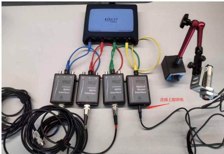
使用 4 通道示波器时，连接方法参考上图。光学传感器一定要连接到通道 D，因为软件规定了使用通道 D 来连接光学传感器。
