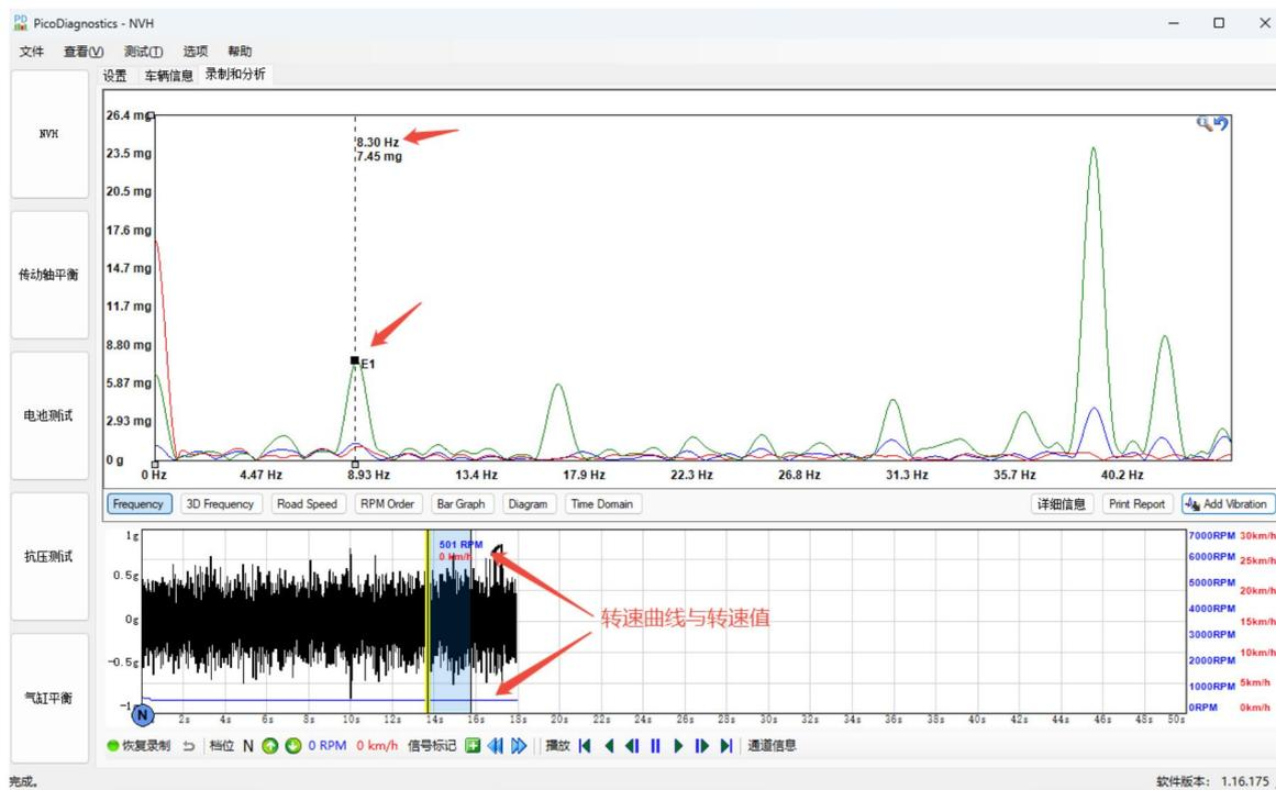
注意：光学传感器输出的转动频率，在软件上显示的为 E1。因为软件设计的初衷是：使用通道 D 来捕捉油车的发动机（Engine）的转速，所以默认显示 E1。
