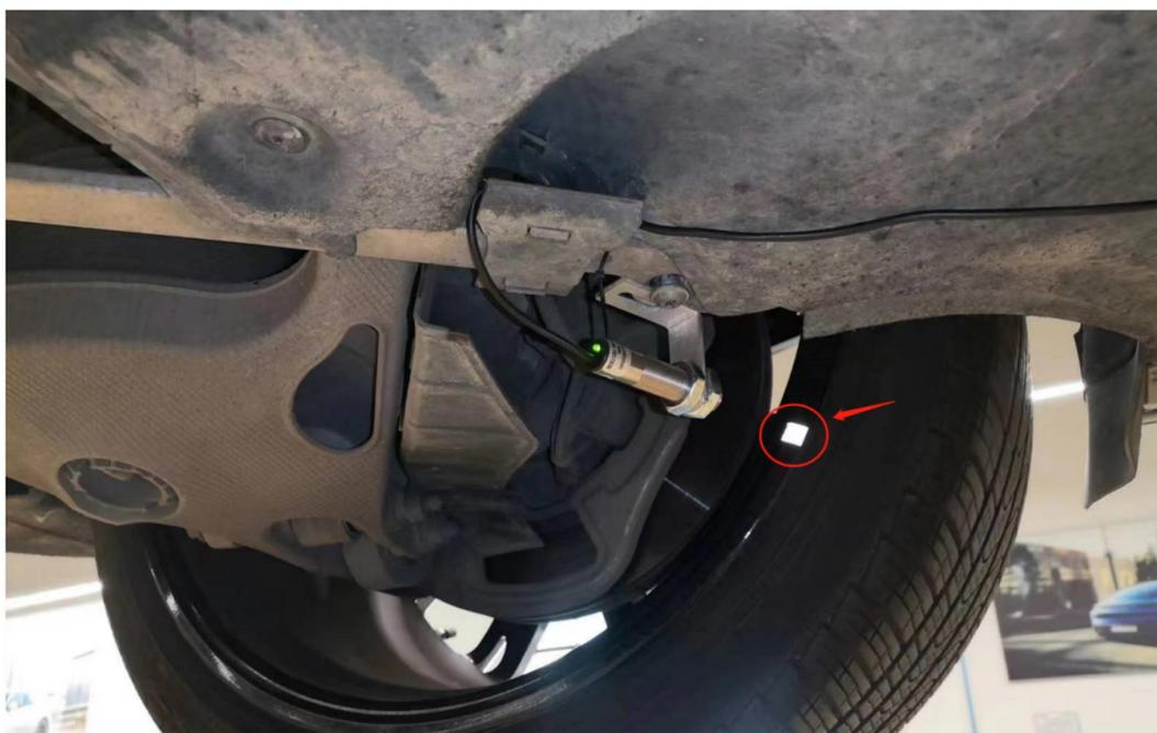
在轮毂上贴一张反光纸或与轮毂颜色差异大的纸（白纸），反光纸的形状要规整。将光学传感器安全并稳固的安装在车上，让光学传感器的红光对准反光纸，然后旋转轮胎，确认光学传感器有信号输出。
